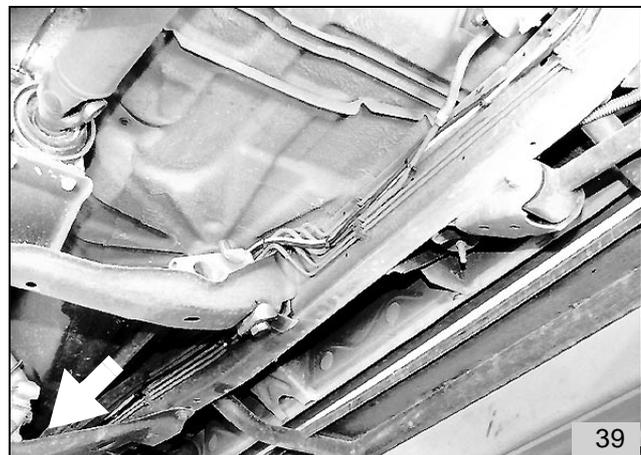
**Brennstoffleitungsverlegung bei Dieselmotor**
