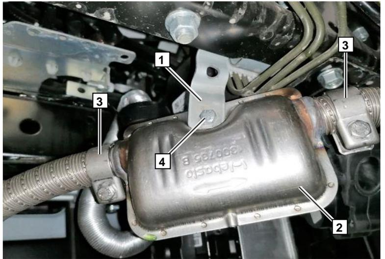
1 дренажное отв. Ø3мм в нижней точке выхлопной трубы
