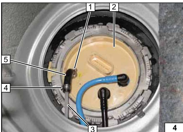
Tankarmatur 2 gemäß Herstellerangaben einbauen! 90°- Formschlauch 5 bei  $\varnothing$  3,5mm um 10mm kürzen!
