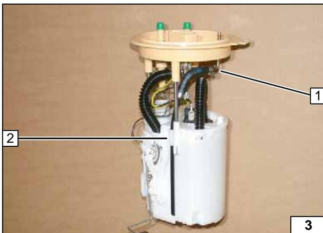
Entnahmerohr durch Durchführung 2 verlegen, Tankentnehmer 1 einsetzen!
