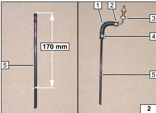
Entnahmerohr 5 schräg ablängen. Tankentnehmer komplettieren. Caillauschelle  $\varnothing$  8mm 2 hinter der Wulst und Caillauschelle  $\varnothing$  10mm 4 zwischen den Wülsten montieren!
