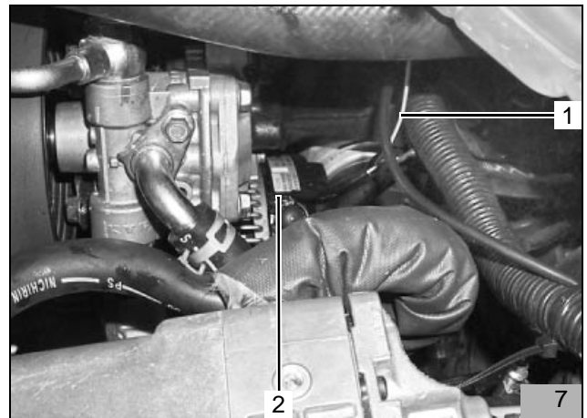
Anschluss-Schema des Theroschalters
