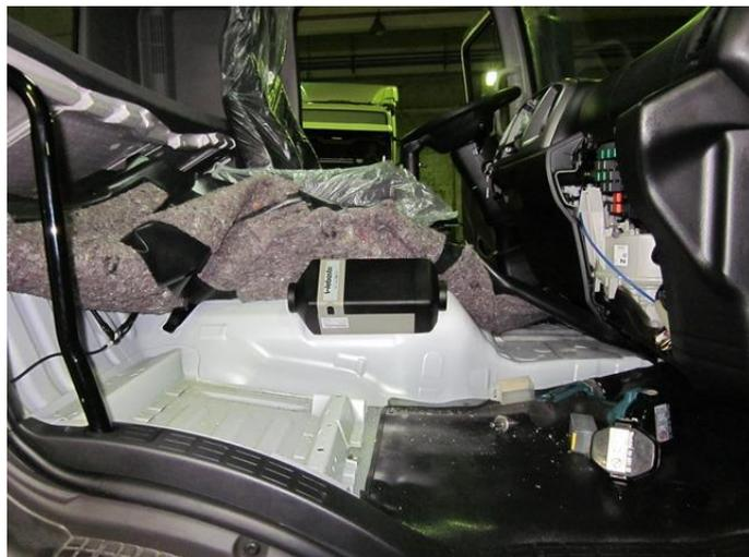
Вырезать отверстие в напольном покрытии по размеру технологического выступа в нижней части подогревателя.
