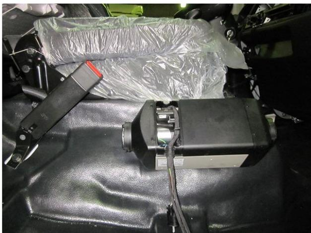
Установить трубки выхлопа, забора воздуха и подачи топлива к соответствующим патрубкам подогревателя.
