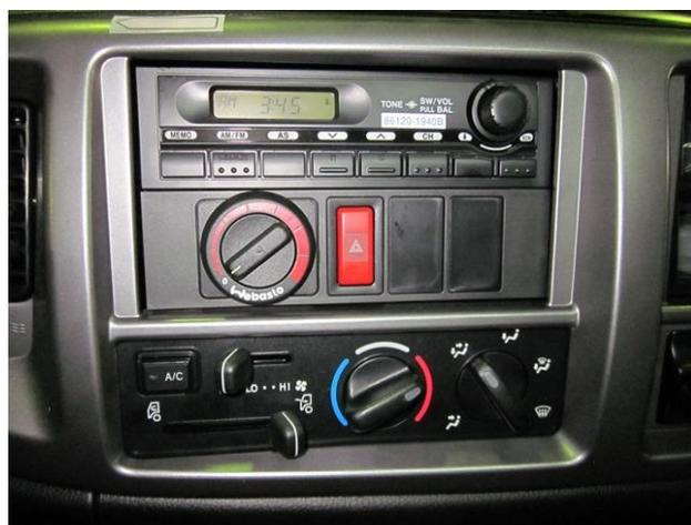
Внешний вид панели с установленным органом управления (поворотный выключатель).
