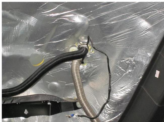
Провести трубки выхлопа и забора воздуха по днищу кабины. Закрепить трубку выхлопа в середине при помощи хомута №405256 к крепежному болту брызговика кабины.
