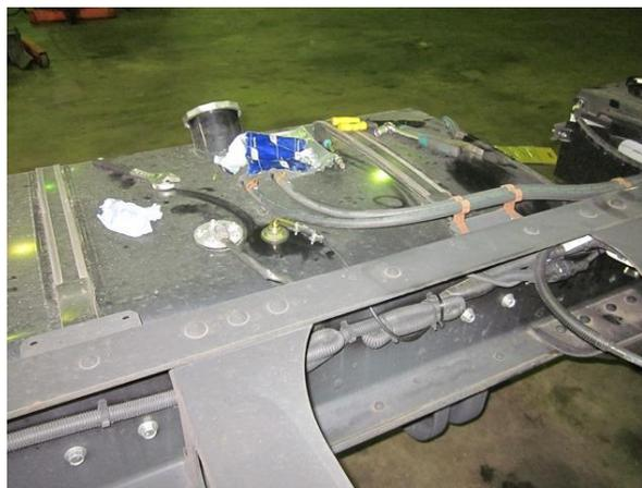
Топливная трубка и жгут на насос-дозатор прокладываются по штатным электрическим жгутам, надежно фиксируются к ним. При опасности повреждения топливной трубки (прохождения отверстия в раме) надеть защитный патрубок.
