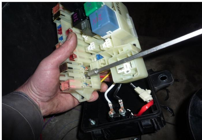
Колodки предохранителей разместить в корпусе блока предохранителей автомобиля
