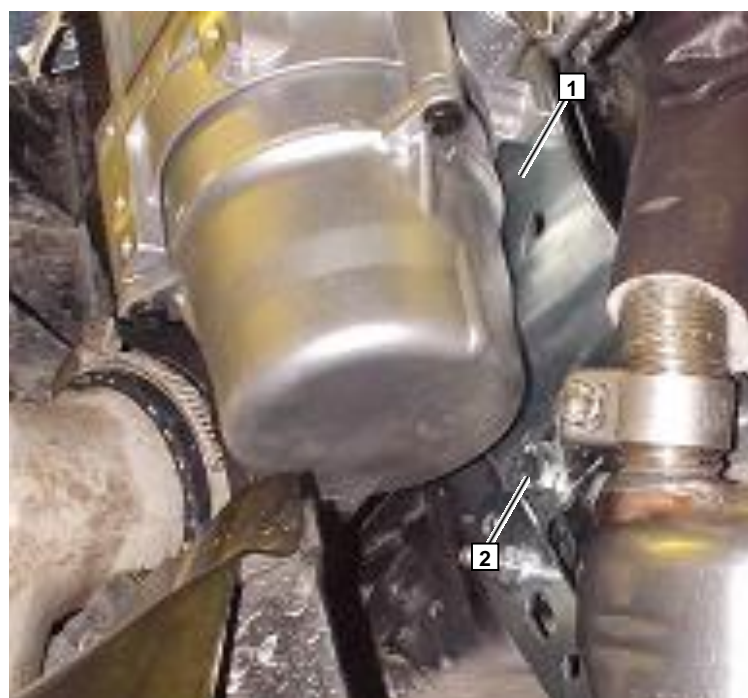
1 Стандартный кронштейн 2 Болт М6х25, гайка, крепление через штатное отверстие
