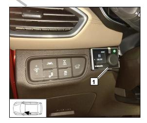
Расположение электронного таймера
