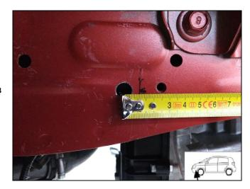
В ранее просверленное отверстие установить закладную гайку и зафиксировать часть составного кранштейна на кузове автомобиля болтом M6x20 1.
