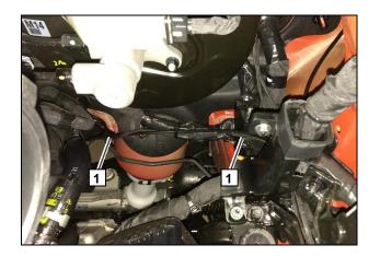
Проложить топливопровод и жгут насосадозатора **1** вдоль штатных топливных трубок под днищем а/м к топливному баку.
