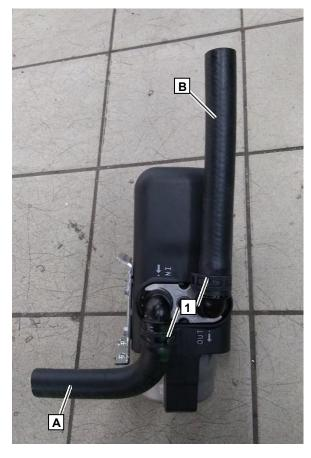
Установить подогреватель **1** на кузов автомобиля, совместив и зафиксировав части составного кронштейна **2**.
