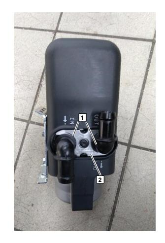
Закрепить часть составного кронштейна **1** на корпусе подогревателя с помощью трех самонарезных болтов M5x13 **2**.
