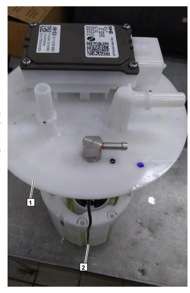
Установить колбу с топливным насосом **1** обратно в бак согласно инструкции завода-изготовителя. Установить соединительный шланг **3** на топливозаборник **2** и подключить топливопровод к насосу-дозатору **4**.
