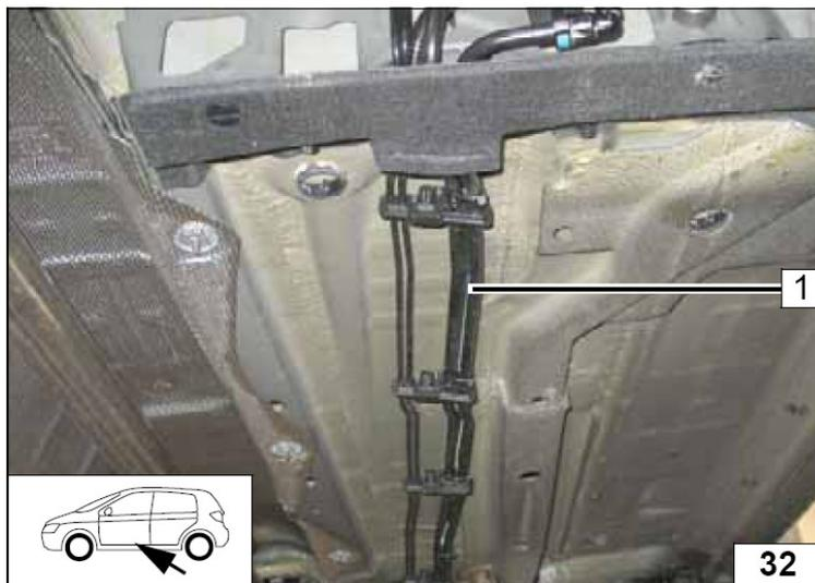
1 Отверстие  $\varnothing$  7 мм, для крепления дозирующего насоса.
