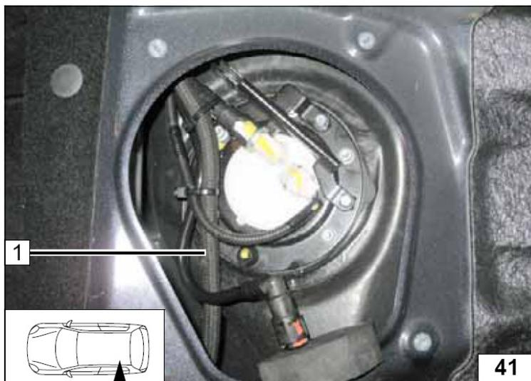
1 Топливопровод в изоляции
