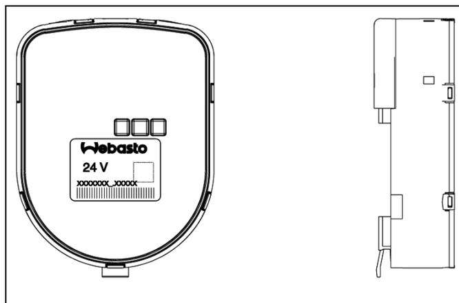
Рис. 15 Блок управления Thermo 90ST установочное положение - любое
