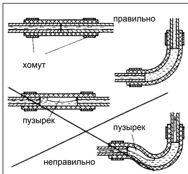
**Рис. 4 Соединение трубы/шланги**
