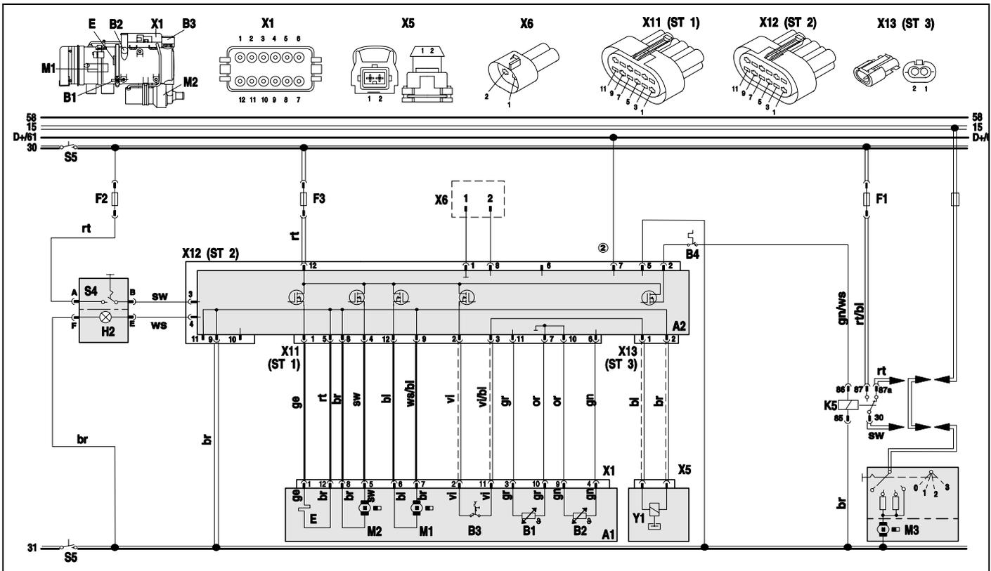
Рис. 18 Электросхема Thermo 90S, 24 В, с выключателем, легенду см. стр. 11-12
