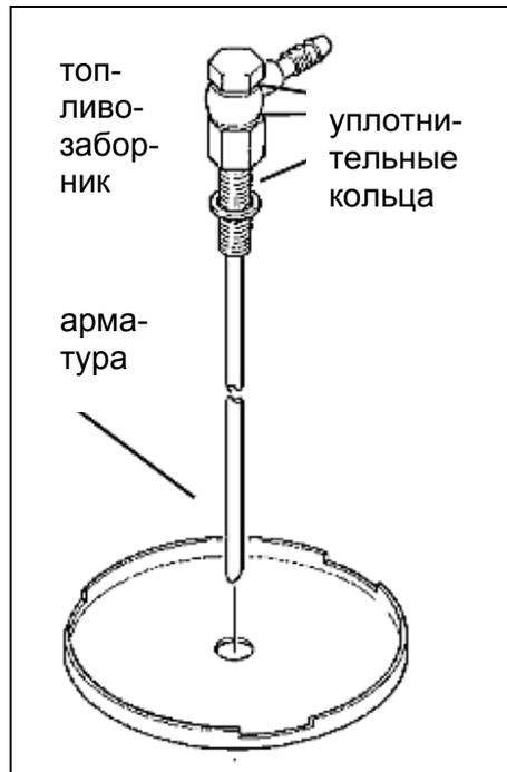
Рис. 5 Только для пластиковых баков (забор через арматуру бака).
