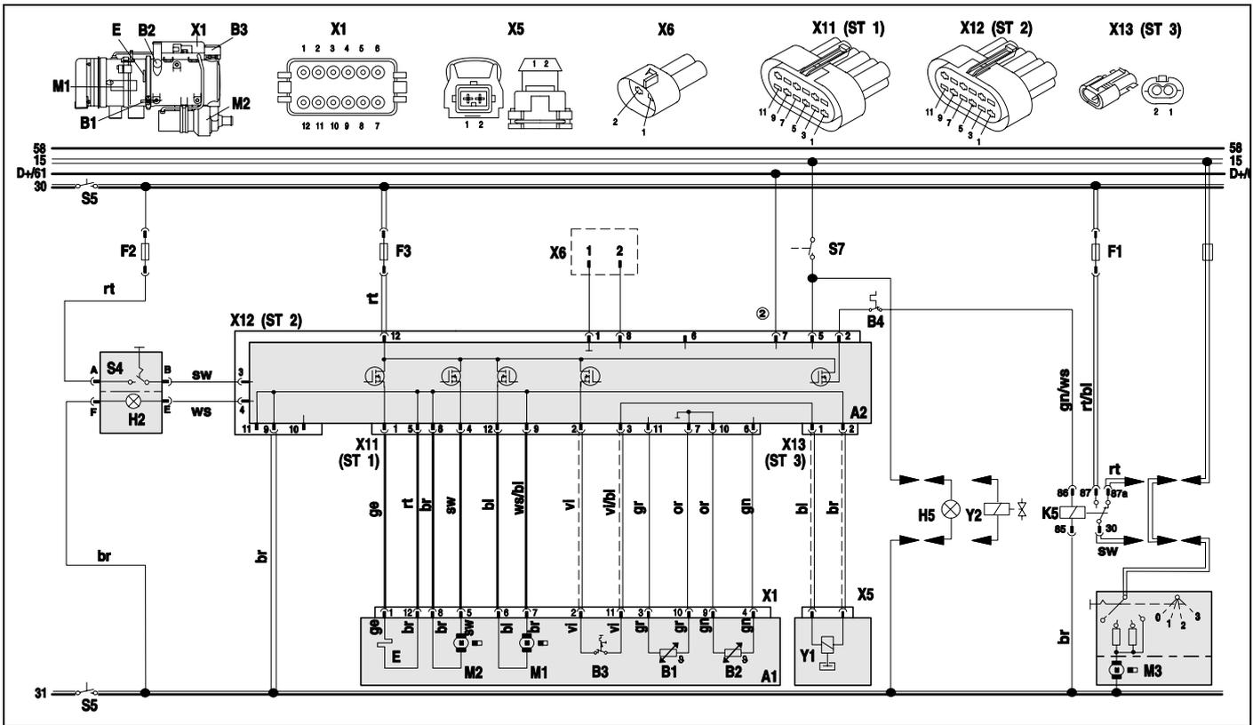
Рис. 17 Электросхема Thermo 90S, 24 В, с выключателем, легенду см. стр. 11-12
