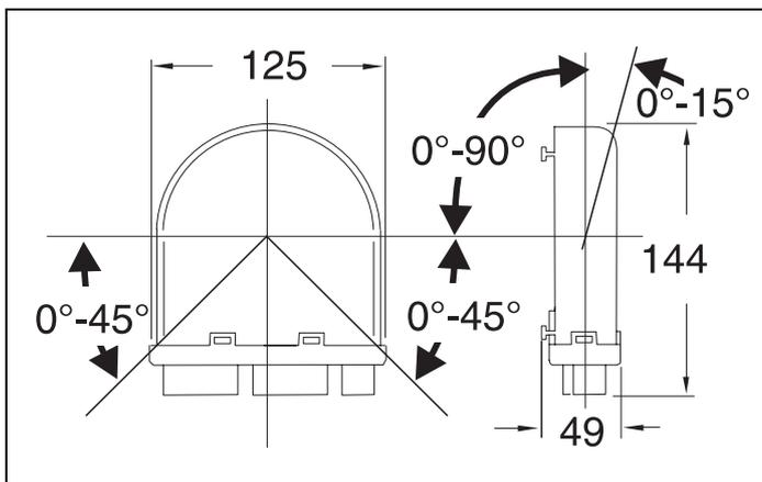
Рис. 14 Блок управления Thermo 90S, установочное положение
