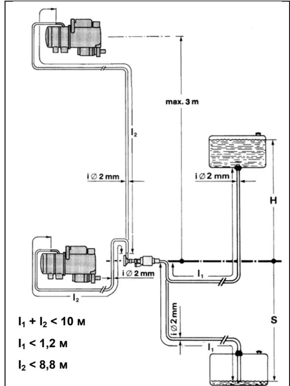
Рис. 4 Система топливообеспечения
