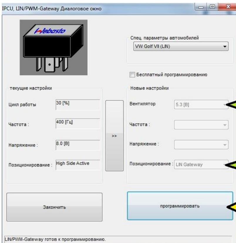
Параметр «Позиционирование» примет значение «LIN Gateway»
