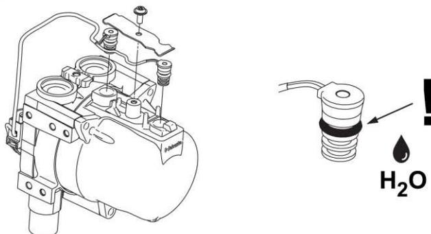
Рис. 918 Смачивание уплотнений
