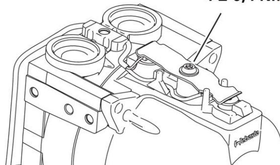
Рис. 921 Затяните винты
