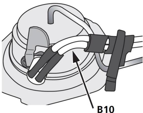
Рис. 915 Расположение кабеля штифта накала с небольшим изгибом
