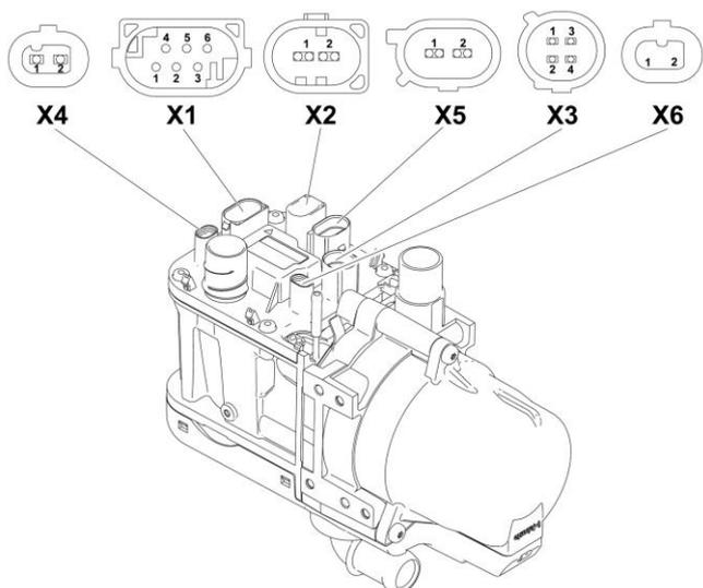
Рис. 916 Узел нагнетателя воздуха для горения с изображенными разъемами (представленный вариант с максимальной раскладкой разъемов)
