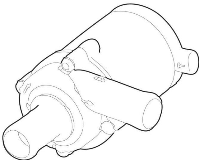
Рис. 205 Циркуляционный насос U4847 Ecom
