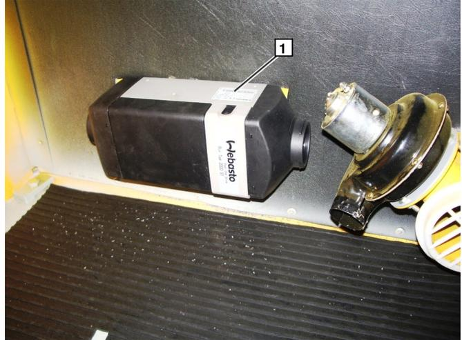
Снять сиденье оператора, снять декоративную панель за сиденьем оператора.
