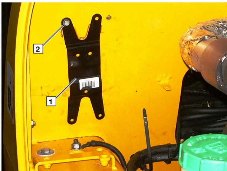
Разметить просверлить два отв 1 в кронштейне и кузове (приметно на 20 мм выше нижних отв крепления кронштейна)
