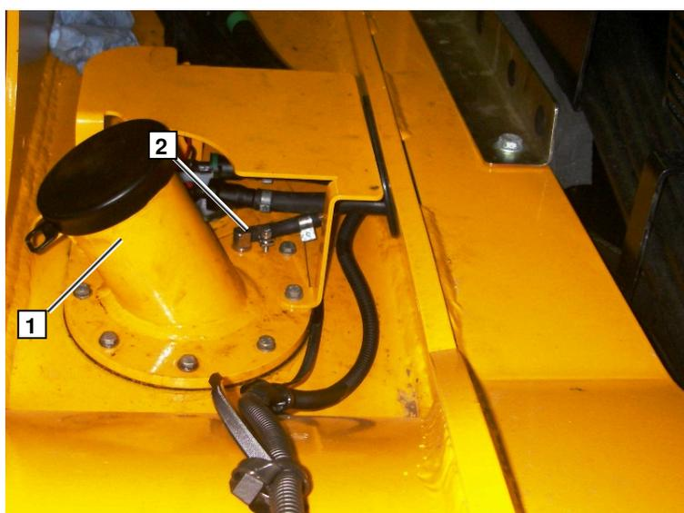
Для установки топливозаборника необходимо снять пластину топливозаливной горловины, отвернув все болты **1** (М6).
