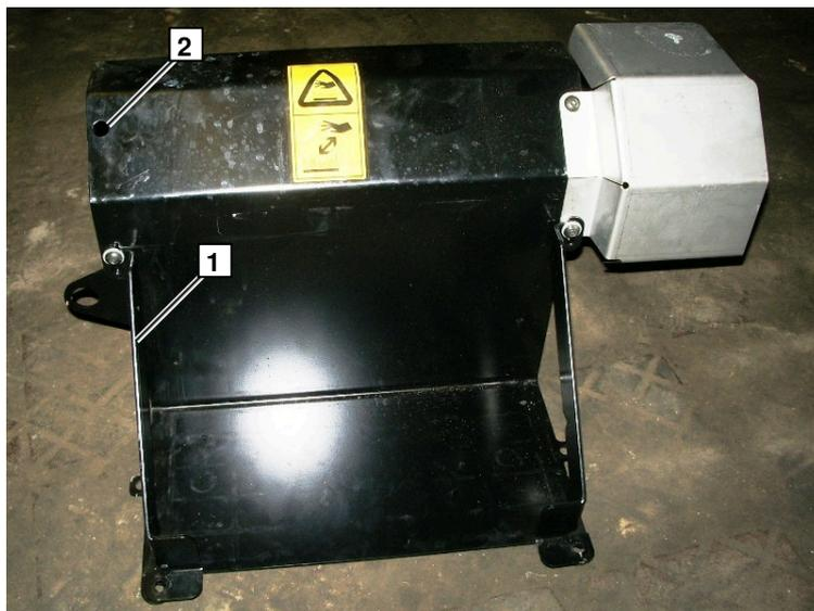
После примерки на а.м. с установленным отопителем на кронштейне АКБ сделать разметку и вырезать участок **2**, а так же при необходимости сделать пропилы от крепления **1**. (3 шт.)
