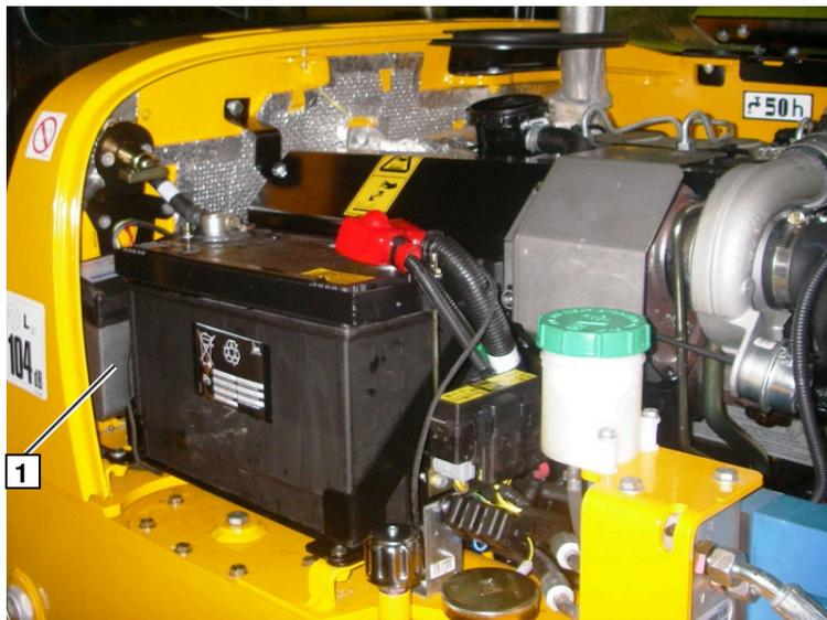
Снять АКБ и аккумуляторную площадку,
