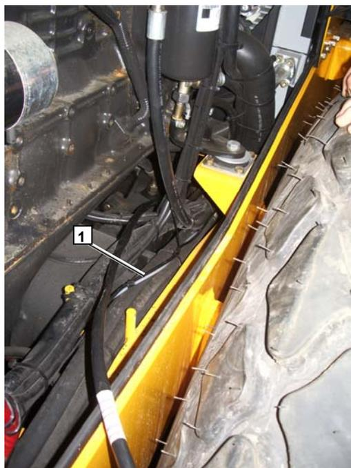
Подсоединить топливопровод к топливному штуцеру отопителя.
