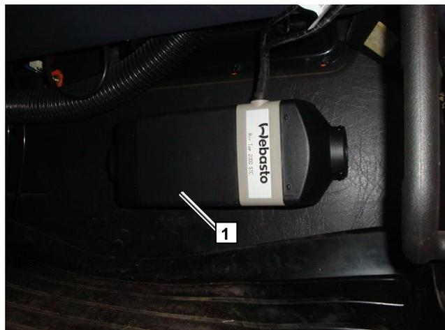
Зафиксировать отопитель на моторном щите гайками М6 1 (4шт.)
