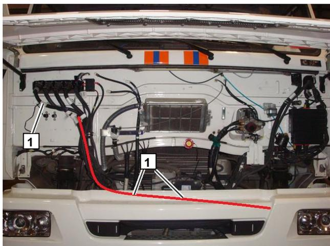
Проложить топливопровод и жгут насоса-дозатора **1** по раме автомобиля, согласно рисунка.
