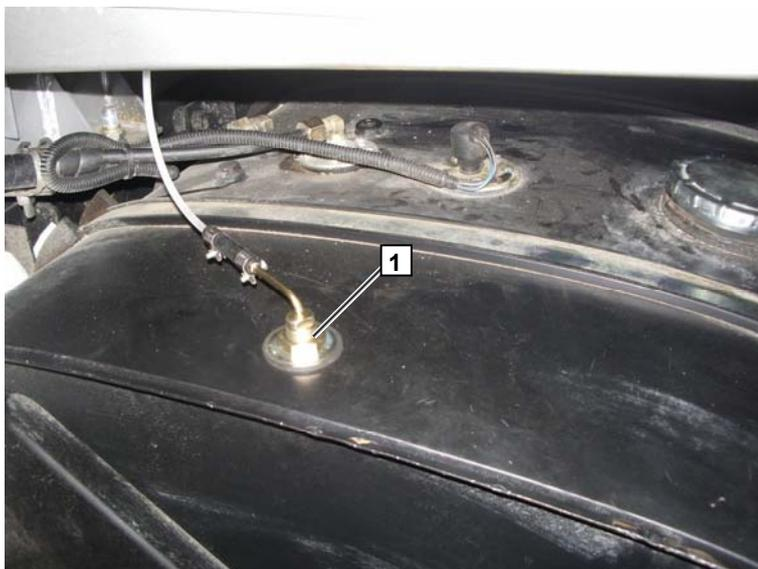
Топливный насос-дозатор расположить как можно ближе к топливозаборнику. Закрепить используя охватывающий хомут и демпфер. Положение насоса – горизонтальное.
