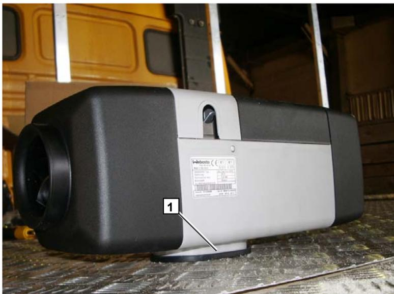
**1** тепловой зазор под отопителем
