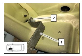
**1** Болт М6 фиксации дополнительного кронштейна
