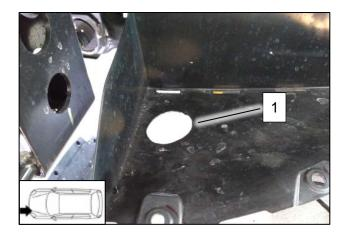
Установить фиксатор **1** – следовать прилагаемому руководству.
