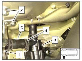
Закрепить кронштейн с подогревателем на кузове автомобиля в ранее подготовленных отверстиях 1 с помощью болтов M6, гаек M6, гроверов.
