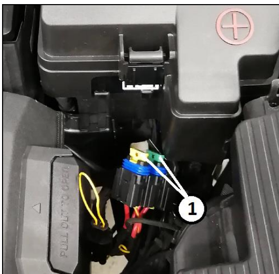
Колodka предохранителей под капотом
