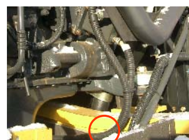
Перекройте шланг водяного охлаждения
