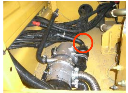
Подсоединение шлангов водяного охлаждения с использованием адаптера и хомута
