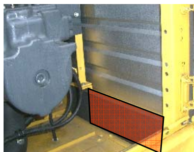
Вырежьте кусок шумопоглощающего материала
