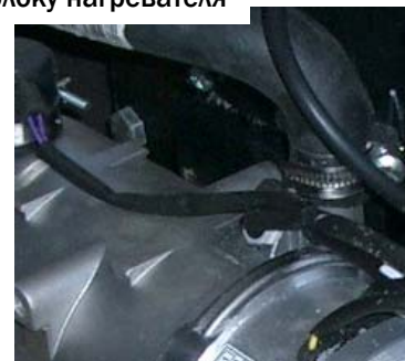
Перекройте шланг водяного охлаждения
