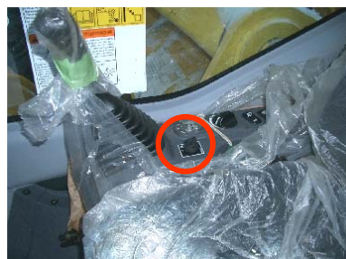
К консоли правого рычага управления - вдоль других жгутов проводов
