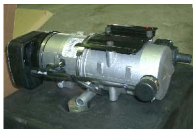
Закрепите нагреватель на кронштейне Webasto
