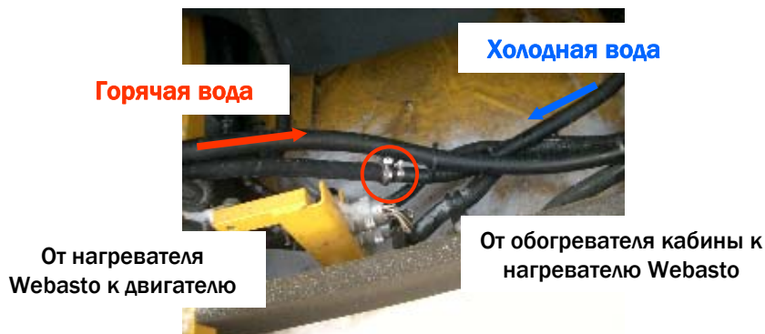
Используя адаптер и хомут, подсоедините шланг водяного охлаждения к линии обогревателя кабины
