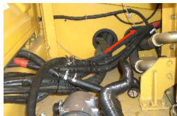
От шланга нагревателя к топливному шлангу (держитесь как можно дальше от двигателя)
