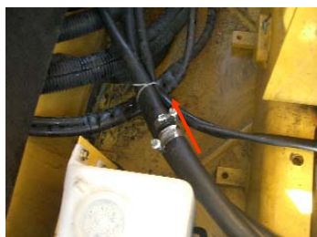
От шланга нагревателя к топливному шлангу
