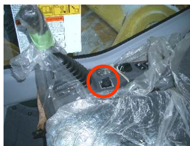
К консоли правого рычага управления – вдоль других жгутов проводов
