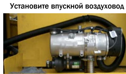
Установите впускной воздуховод
