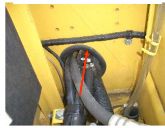
Вдоль шланга нагревателя к водоотделителю
