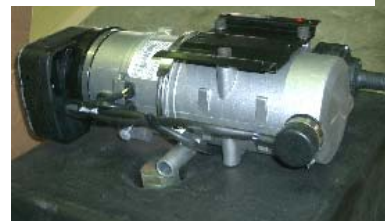
Закрепите нагреватель на кронштейне Webasto
