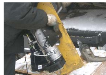
Установите блок нагревателя с кронштейном Webasto и L-образным кронштейном
