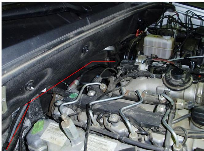
Топливная трубка спускается под днище автомобиля с левой стороны.
