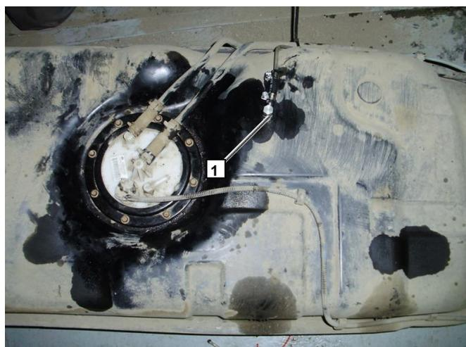
Топливный насос устанавливается под днищем автомобиля, на раме, возле бака, для крепления используется штатная закладная гайка.
