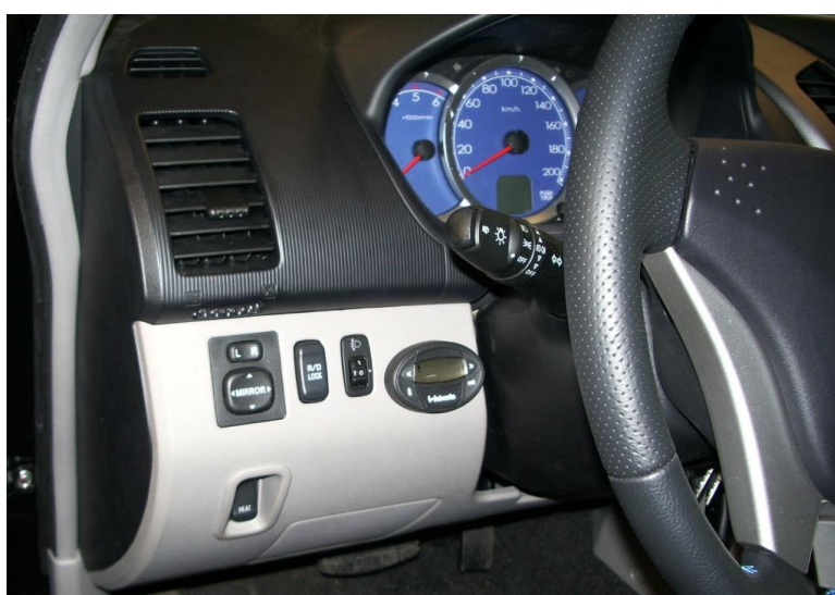
Место установки минитаймера - слева от руля. Внимание в районе его установки (сверху) расположен металлический кронштейн
