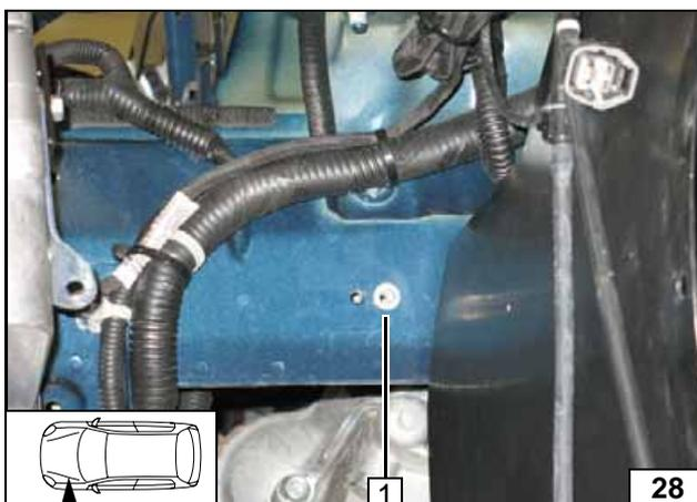
1 Bohrung Ø 9,1; Einnietmutter einziehen
