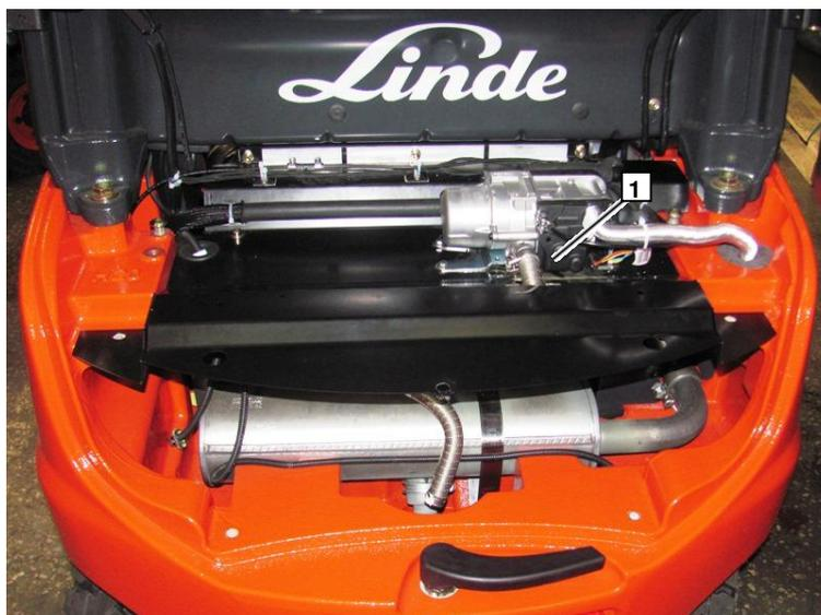
Для крепления выхлопного глушителя **1** использовать Г-образный кронштейн и монтажную планку их комплекта
