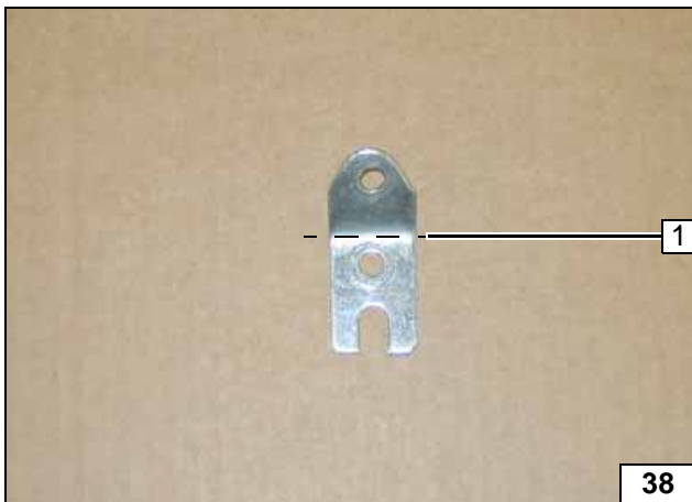
Lochband Teil 2 an Biegelinie 1 um 130° biegen!
