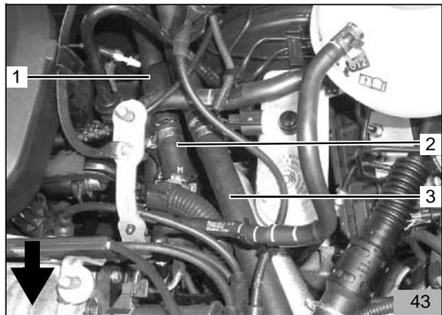
**Wassereinbindung 1,4 I Benzinmotor**
