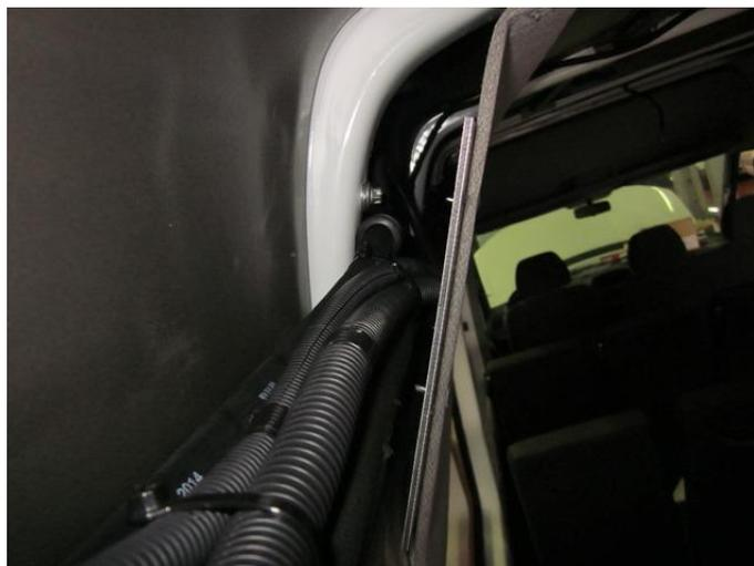
Вид на пространство между кузовом и боковыми обивками, внутри проложены трубки с фреоном и жгут проводов.
