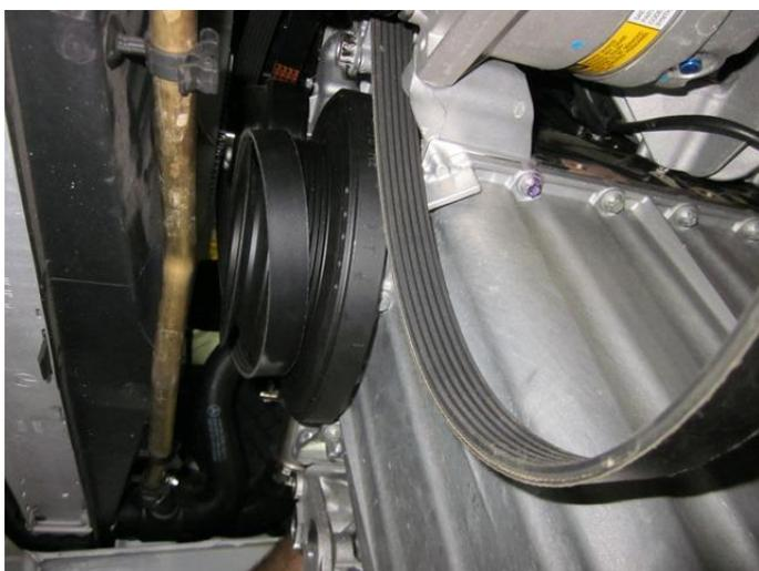
Подготовить к установке компрессор Sanden SD7H15 , клиновой ремень 13x950, два болта крепления M10x1,5x130 и две гайки M10x1,5.
