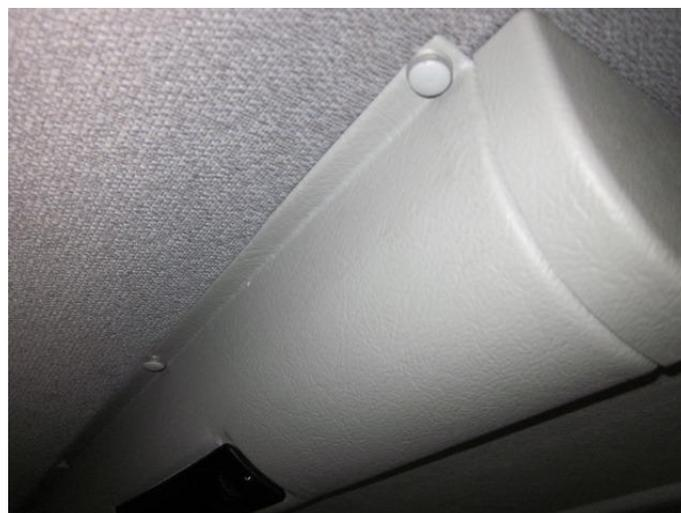
Вид на установленный канал подачи воздуха справа и панель забора воздуха.
