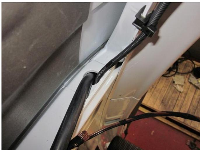
Прокладка трубки слива конденсата в задней левой стойке кузова.
