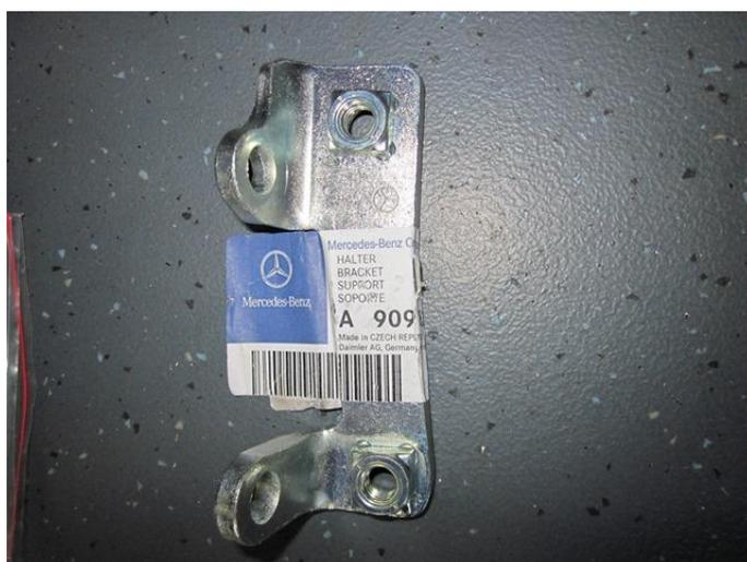
Закрепить кронштейн компрессора на двигателе болтами M8x1,25 , момент затяжки 25 Нм.
