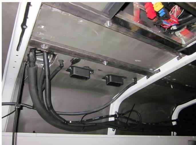
Установить стаканы подачи охлажденного воздуха справа. В случае если фланец стакана не прилегает плотно к покрытию потолка, то рекомендуется промазать стык силиконовым герметиком.
