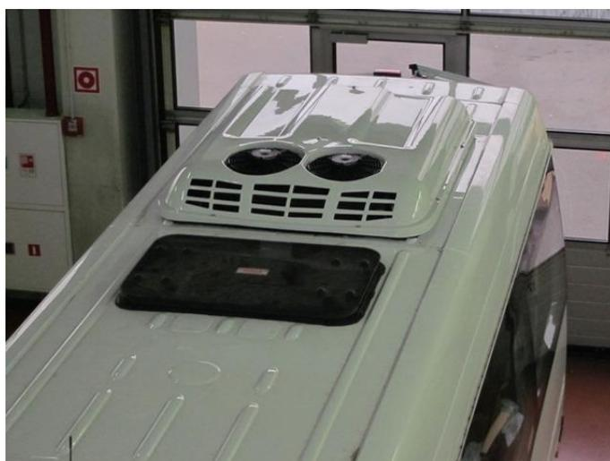
Вид на установленный кондиционер сбоку.
