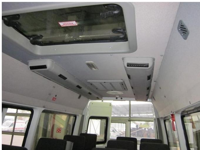
Установка крепежных элементов канала подачи воздуха.
