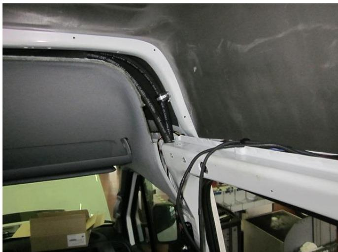
1. Отверстия в полке каркаса для прохода трубок в стойке кузова.
