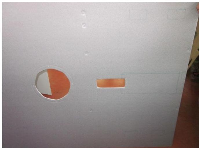
Вырезать отверстия под забор и подачу воздуха кондиционером. Отверстие под плафон перенести в заднюю часть панели, провода удлинить.
