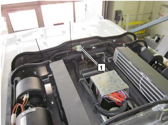
Провода с наконечниками установить в колодку регулятора скоростей вентиляторов в порядке, указанном на картинке :
