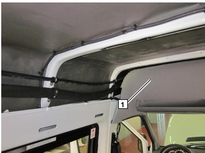
Перекинуть трубки над потолочной панелью над водителем с левого борта на правый и закрепить на поперечине кузова.
