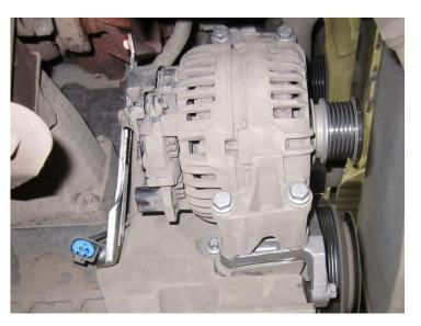
При натяжке ремня привода компрессора использовать специальный динамометрический ключ 16
