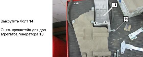
Снять кронштейн для доп. агрегатов генератора 13
