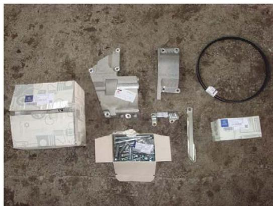
Заменить штатный шкив коленчатого вала на модификацию для установки компрессора.
