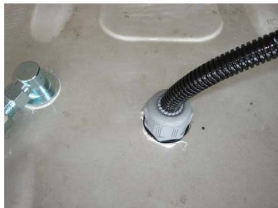
Накрышный блок установить на резиновые втулки-демпферы. Нанести на привалочные поверхности слой герметика.
