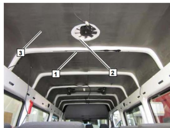
Удалить накрывной вентилятор, отверстие в крыше закрыть крышкой 1, уплотнив герметиком 2.
