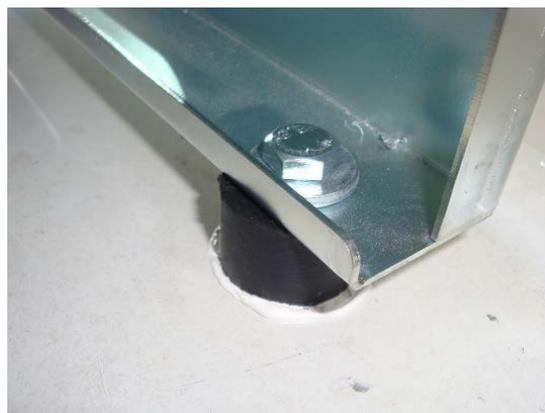
Закрепить накрышный блок болтами 1, закрутив их сквозь отверстия в крыше в наваренные на кронштейны 2 гайки 3.
