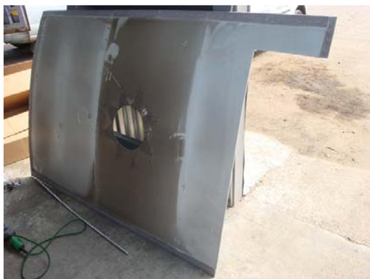
Вырезать в задней левой декоративной панели проем для шлангов и жгутов проводки. Защитить острые кромки.
