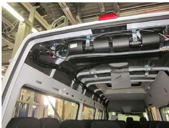
Прорезать проход для шлангов в стойке кузова.
