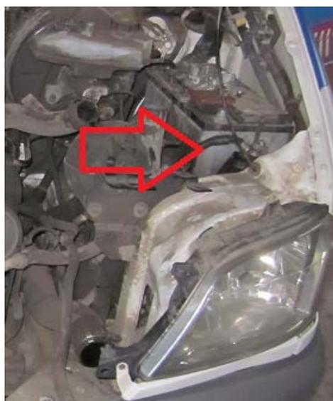
Проложить жгут **1** проводов в моторном отсеке и подключить к компрессору кондиционера.
