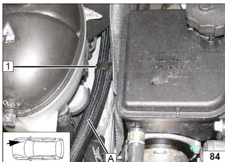
1 Подключение к циркуляционному насосу.
