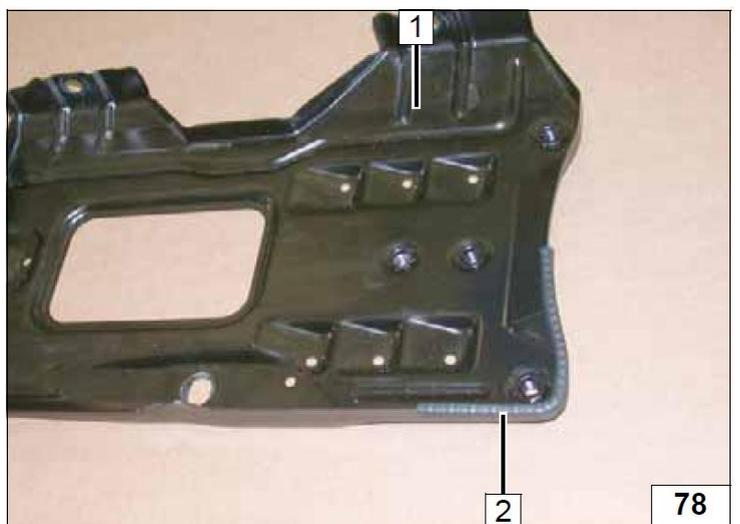
1 Отверстие Ø 8 мм
