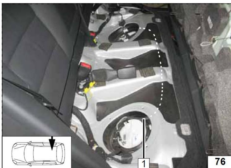
1 Топливопровод и жгут проводов в изоляции.
