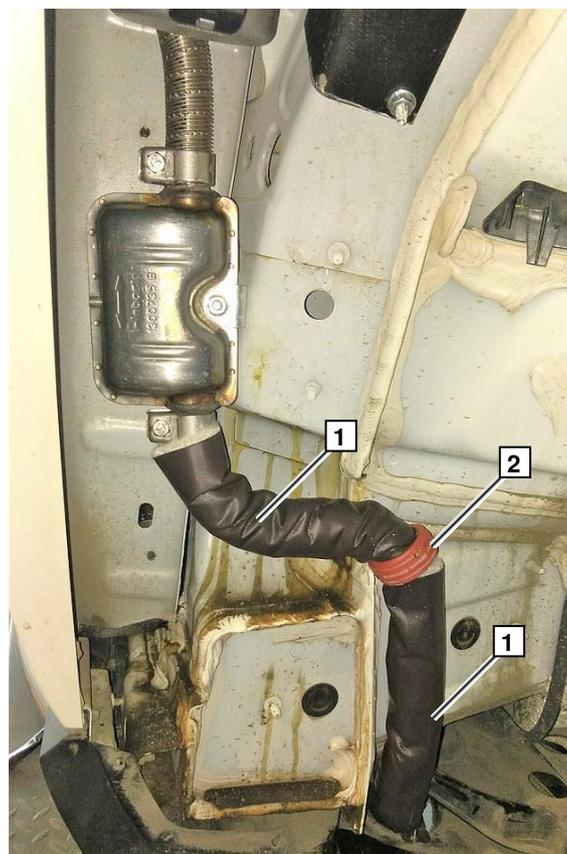
1 оконечная часть выхлопной трубы
