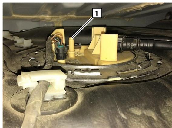
Укоротить трубку топливного заборника **1** до размера до длины 190мм
