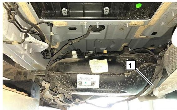
Отрезать кончик трубки топливного заборника **1**
