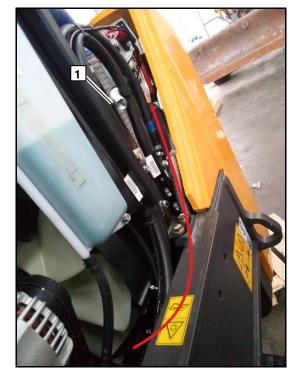
Конец выхлопной трубки **1** сориентировать вниз. Проложить трубку в моторном отсеке, используя в нижней части вторую термозащитную изоляцию **2**.
