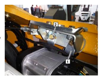
Закрепить подогреватель на кронштейне с помощью самонарезных болтов **1** 5х13 (7нМ).
