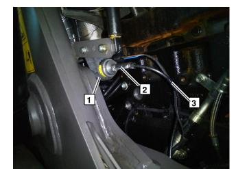
Подключить насос-дозатор 1, согласно рисунка.
