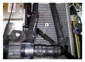
Дополнительный кронштейн подогревателя **1** закрепить на опорной планке радиатора охлаждения двигателя **2** гайкой М8. Для этого разметить и просверлить дополнительное отверстие в кронштейне подогревателя.
