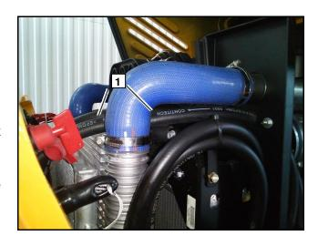
Примерить и, при необходимости, укоротить шланги 1. Подключить соответствующие шланги к штуцерам подогревателя и циркуляционного насоса, предварительно наполнив их и теплообменник подогревателя охлаждающей жидкостью.
