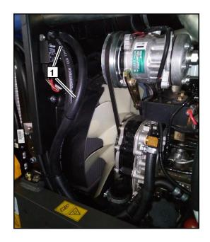
Проложить шланги **1** в переднюю часть моторного отсека в соответствии с рисунком, огибая конструктивные элементы.
