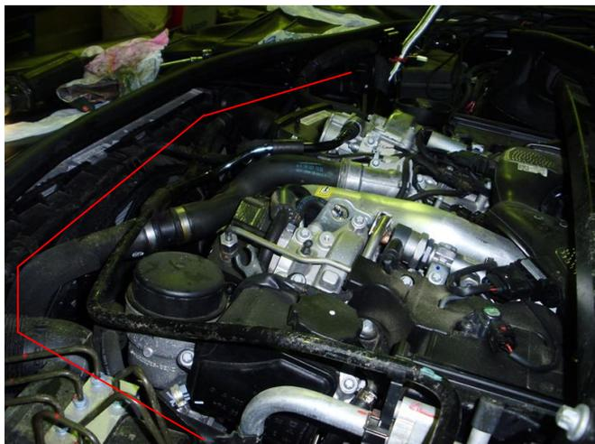
Топливная трубка спускается под днище автомобиля с левой стороны, под тепловой защитой мотора.
