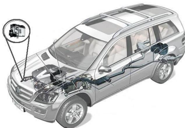
1. предпусковой подогреватель, установочное положение – горизонтально, на боку, поперек направления движения автомобиля.
