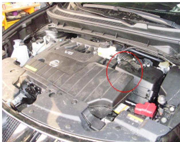
Разрезать штатный шланг предварительно пережав струбцинами.
