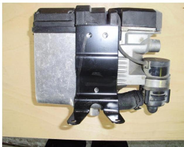
Дополнительный кронштейн 1 изготавливается из полосы железа
