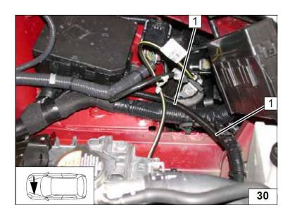
Топливопровод и жгут проводов топливного насоса в гофрированной изоляции.
