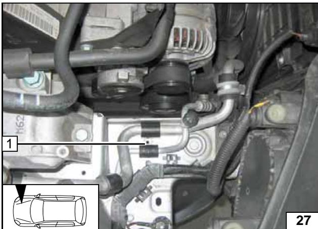
Kunststoffdübel an Position 1 entfernen und Bohrung auf  $\varnothing$  9,1 aufbohren.
