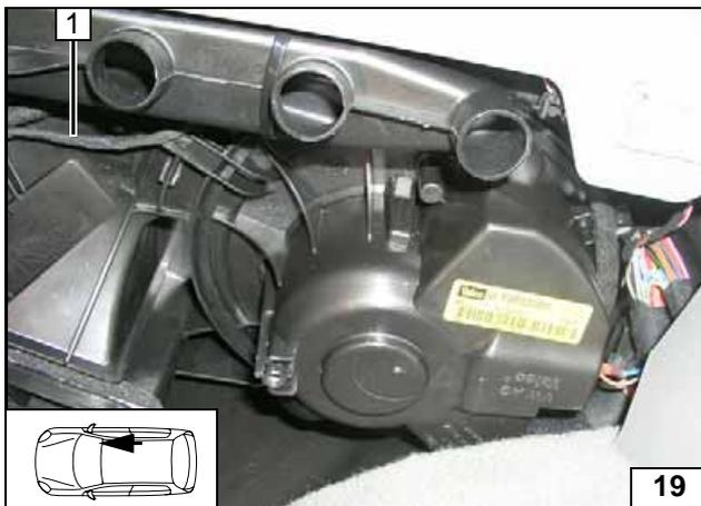
Gebläseeinheit wieder befestigen! Kabelbaum 1 an fzg.eigenen Leitungen mit Kabelbinder befestigen!
