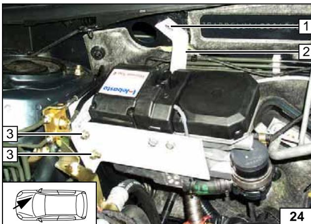
Heizgerät und Strebe ausrichten. Lage der Bauteile kontrollieren, wenn nötig korrigieren. Auf Freigängigkeit achten!
