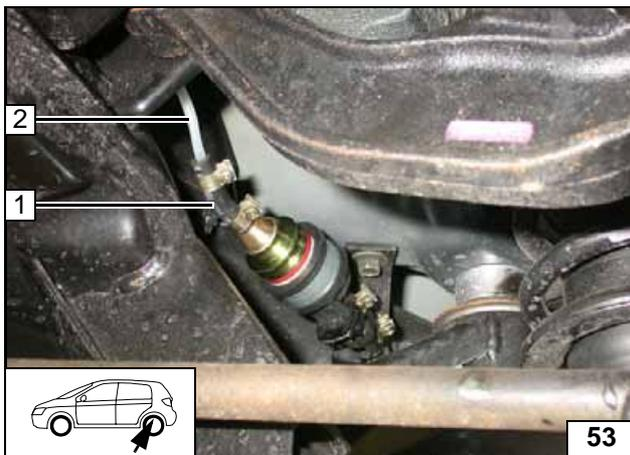
Brennstoffleitung vom Brennstoffentnehmer an Saugseite der Dosierpumpe [Seite ohne Stecker].
