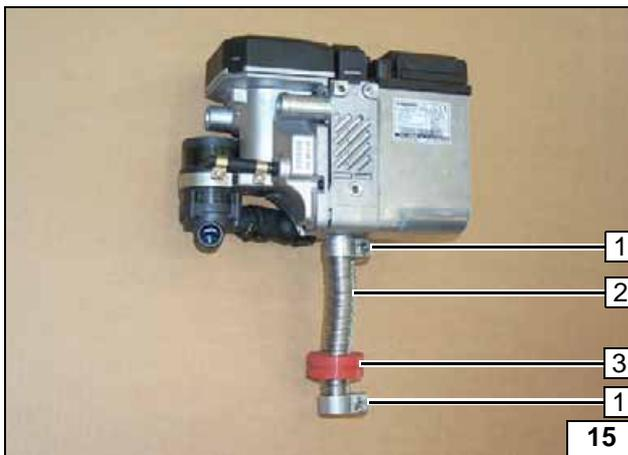
Untere Schlauchklemme lose montieren!
