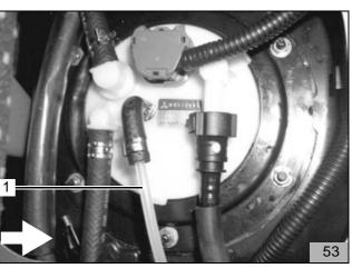
Mecanyl-Brennstoffleitung (54/2) mit Schlauchstück (54/1) und Schlauchschellen 10mm an der Saugseite der Dosierpumpe (Seite ohne Stecker) befestigen
