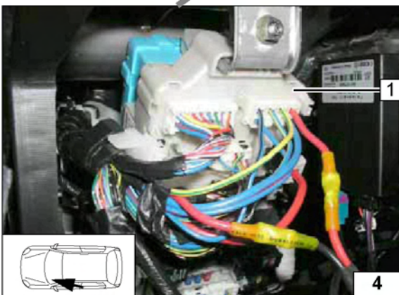
Центральное распределительное устройство
