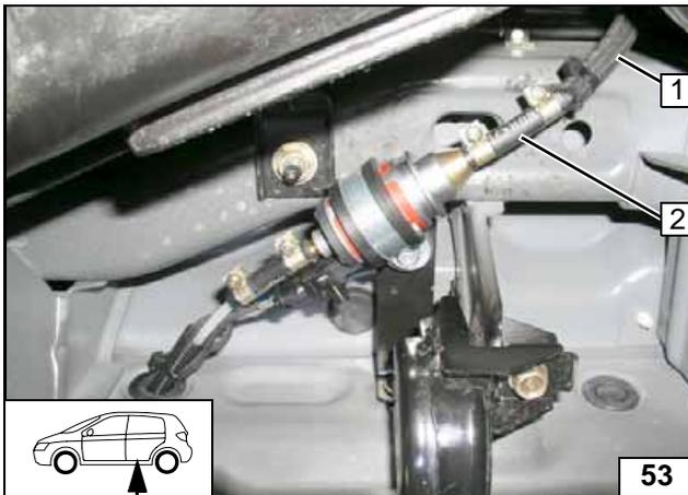
Schlauchstück 1 gfs. als Scheuerschutz auf Brennstoffleitung aufschieben und mit Kabelbinder sichern!
