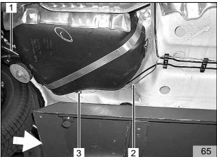
Schutzschlauch (66/1) auf 400 mm ablängen und soweit wie möglich über die Mecanyl-Brennstoffleitung schieben
