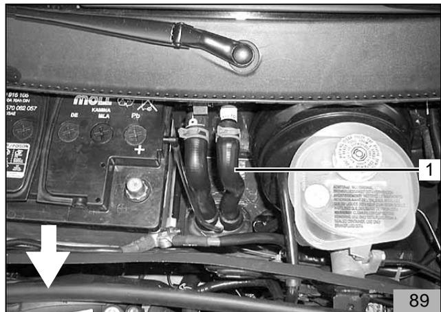
**Schlauchgruppe mit Rückschlagventil einbauen**
