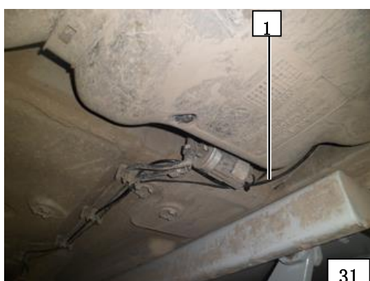
1 燃油管及燃油泵线束
