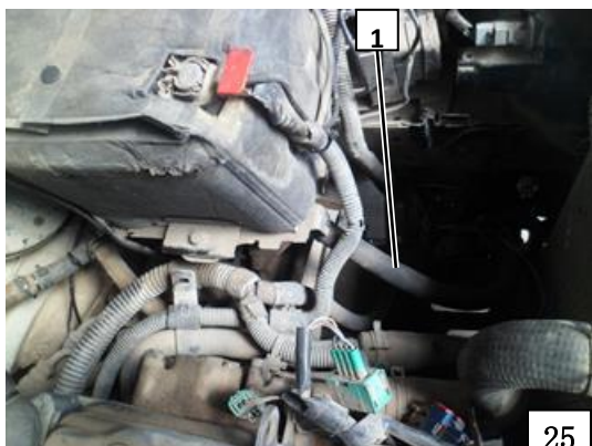
1 发动机到水泵水管
