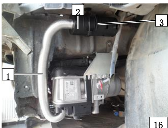
1 进气管 2 进气消音器 3 扎带
