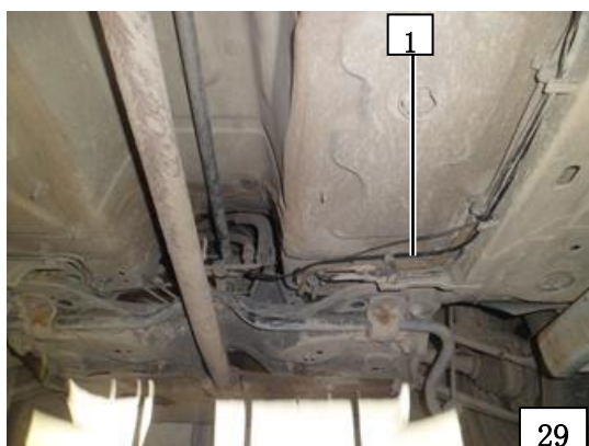
1 燃油管及燃油泵线束
