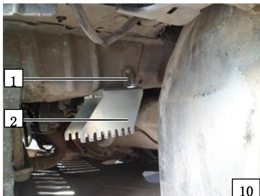
1 L型支架 2 加热器固定支架 (1313986A)
