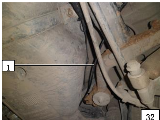
1 燃油管及燃油泵线束
