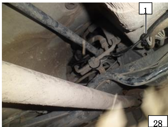
1 燃油管及燃油泵线束
