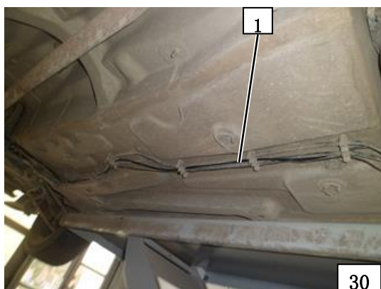
1 燃油管及燃油泵线束
