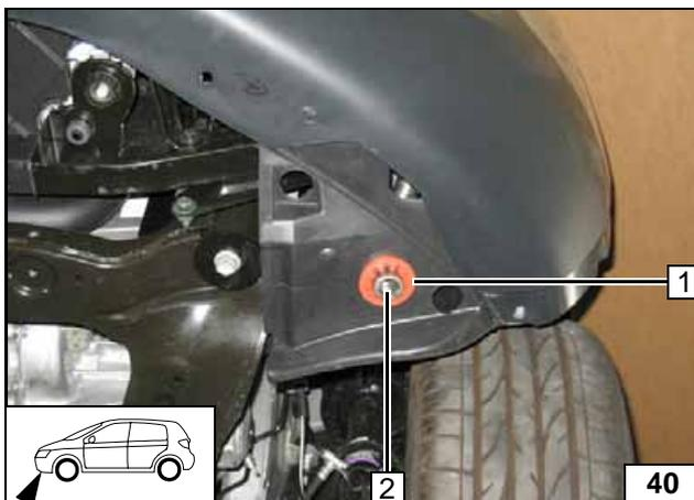
Abgasendstück 2 bündig am Profilgummi rot 1 ausrichten!
