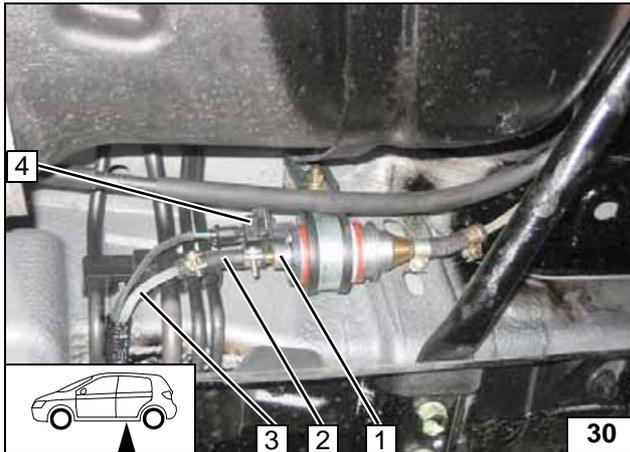
Brennstoffleitung 3 vom Heizgerät an Druckseite der Dosierpumpe 1.
