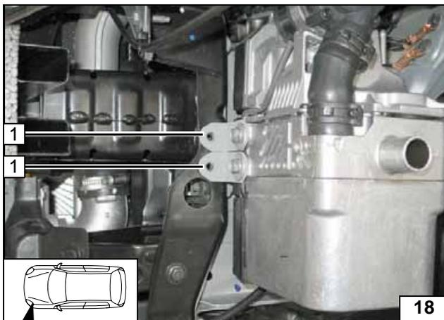
Heizgerät ausrichten. Bohrung Ø 6,5mm [2x] an Position 1!
