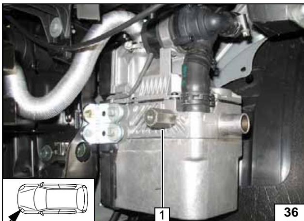
1 Distanzmutter 30mm an Ejotstehbolzen
