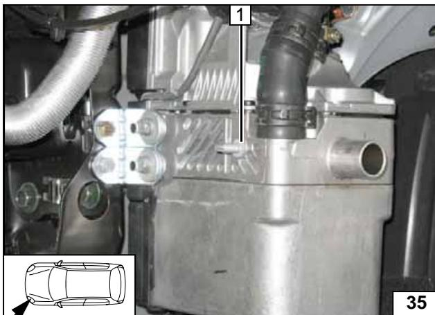
Ejotstehbolzen 1, Anzugsdrehmoment 10 Nm!
