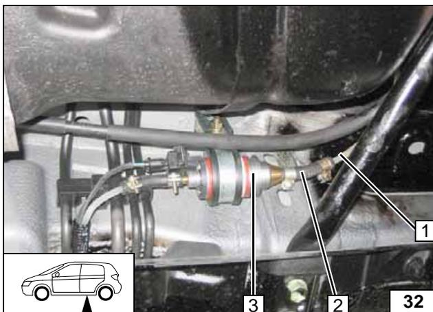
Brennstoffleitung 1 vom Brennstoffentnehmer an Saugseite der Dosierpumpe 3.
