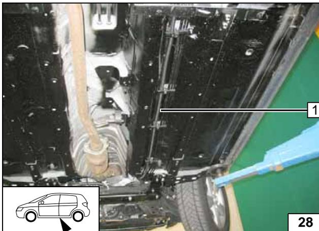
Brennstoffleitung vom Heizgerät und Kabelbaum Dosierpumpe in Wellrohr 1 gemäß Bild verlegen und mit Kabelbindern sichern!
