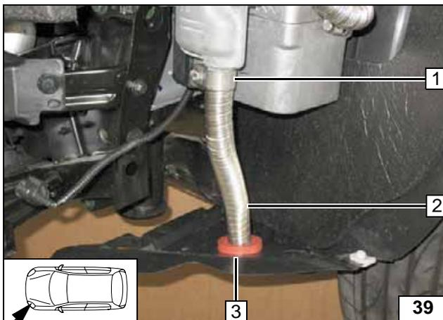
Bohrung Ø 42mm in Radhausverkleidung an Position 3!
