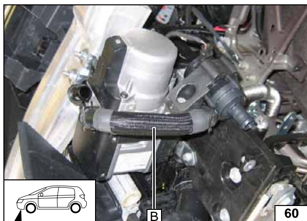
Schlauch B mit 90°- Bogen am Heizgerä- eingang montieren.
