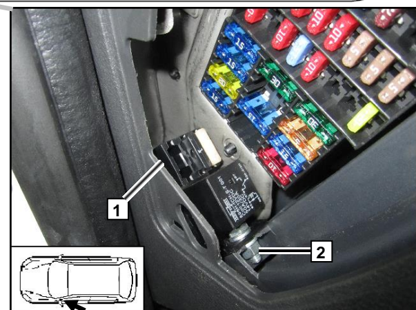
Салонный блок реле и предохранителей
