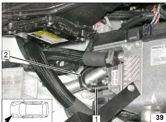
1 Топливопровод и жгут проводов дозирующего насоса в гофрированной изоляции.
