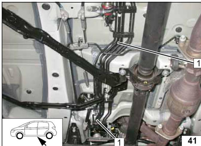
1 Отверстие Ø 9,1 мм, закладная гайка.
