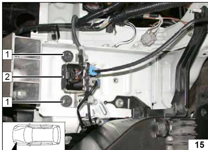
На позиции 1 и 2 просверлить отверстия  $\varnothing 9,1$  мм и установить закладные гайки.
