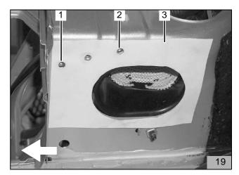
Bohrungen (20/1,2) ø 9mm gemäß Bild 20 bohren und Einnietmuttern einsetzen
