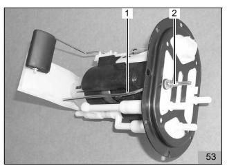
Beiliegenden 90°-Formschlauch (54/3) (Innendurchmesser von 3,5mm auf 4,5mm anwachsend) am Ende mit Innendurchmesser 3,5mm um 5mm kürzen
